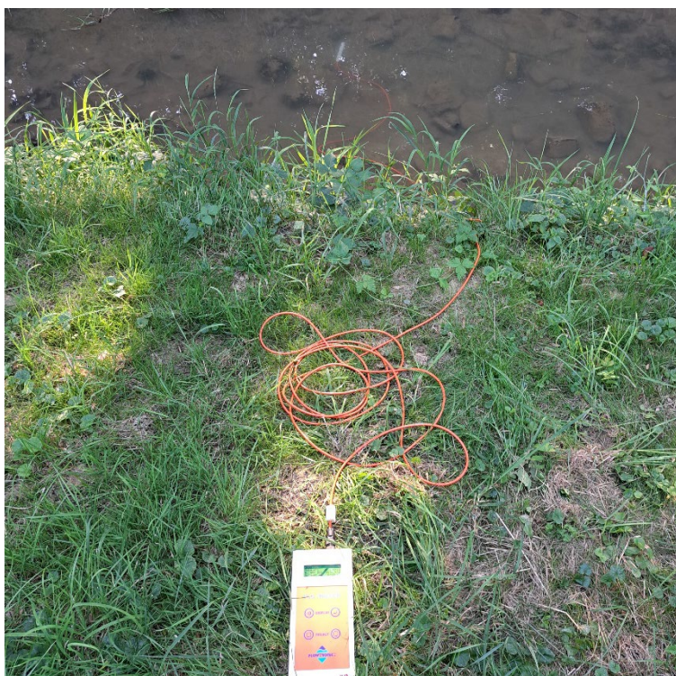
Slika 29: Merjenje pretoka s pomočjo merjenja koncentracije soli v vodi
