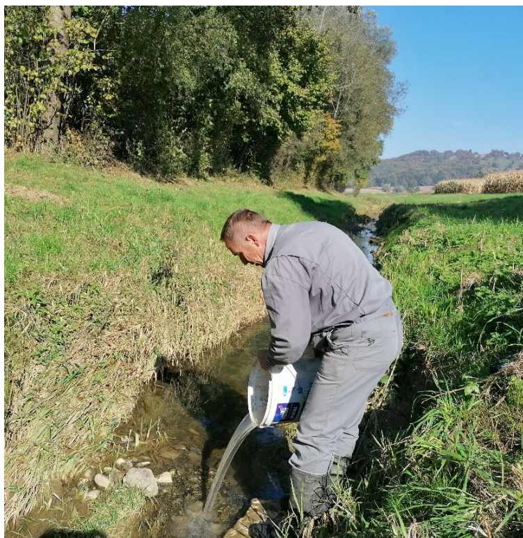
Slika 28: Vnos solne raztopine v potok gorvodno od mesta merjenja koncentracije soli
