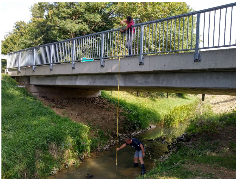
Slika 5: Ročna meritev nivoja gladine od reperske točke z metrom ali z niveliranjem.
