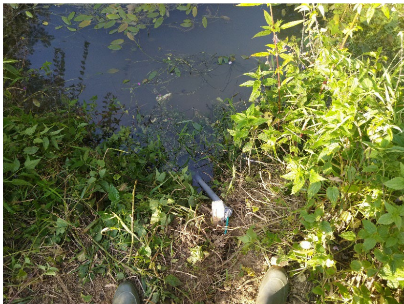
Slika 2: Vgradnja potopne merilne sonde, ki se nahaja v zaščitni cevi, v strugo vodotoka.
