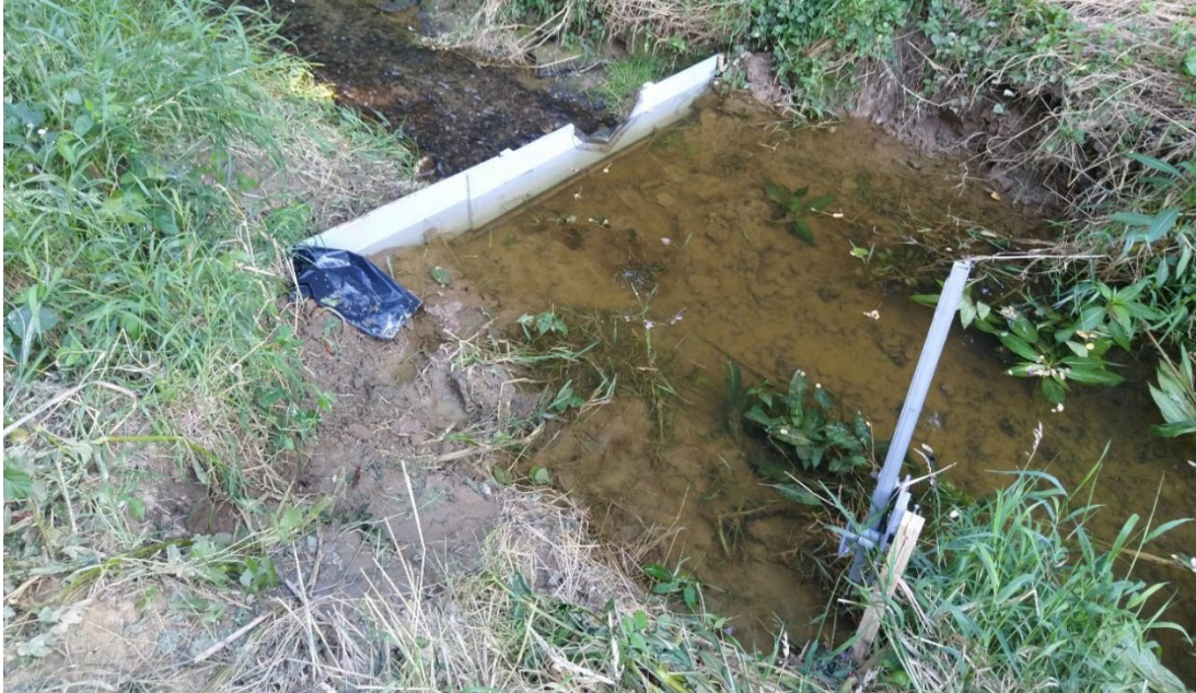
Slika 30: Nameščen tankostenski merski preliv na Kučnici na merilnem mestu 3
